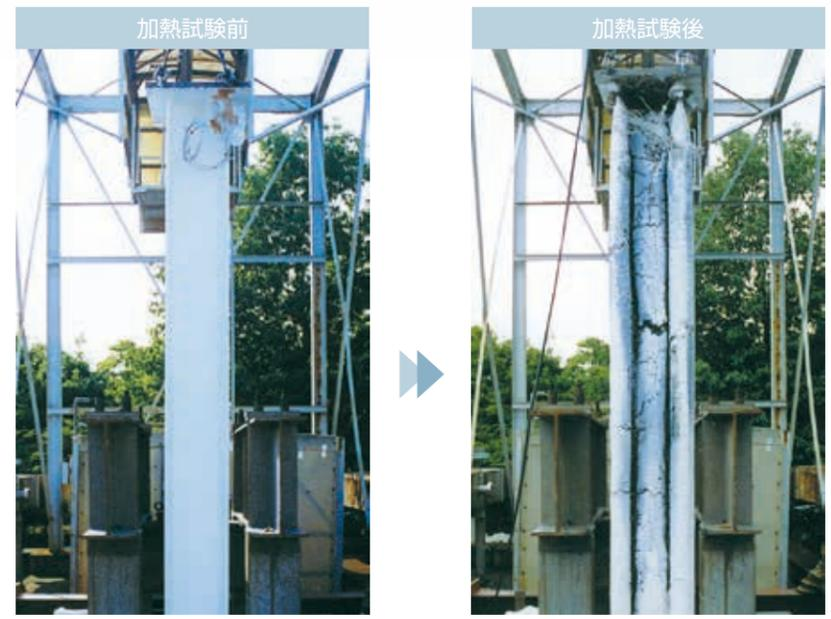
柱 (H-300×300) の荷重加熱試験 (試験機関: 日本建築総合試験所)
